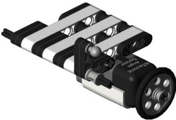
Le robot possède uniquement deux roues ce qui lui permet d'avoir des déplacements faciles à contrôler.
